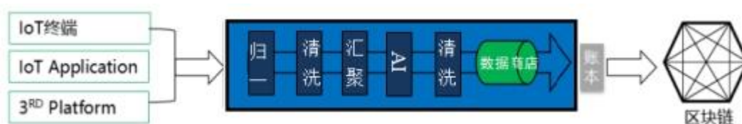
图 21 IoT平台的区块链数据记账流程图
