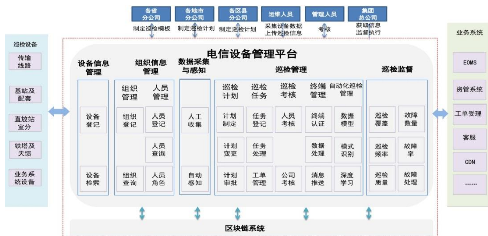
图 3 电信设备管理平台的功能架构图
